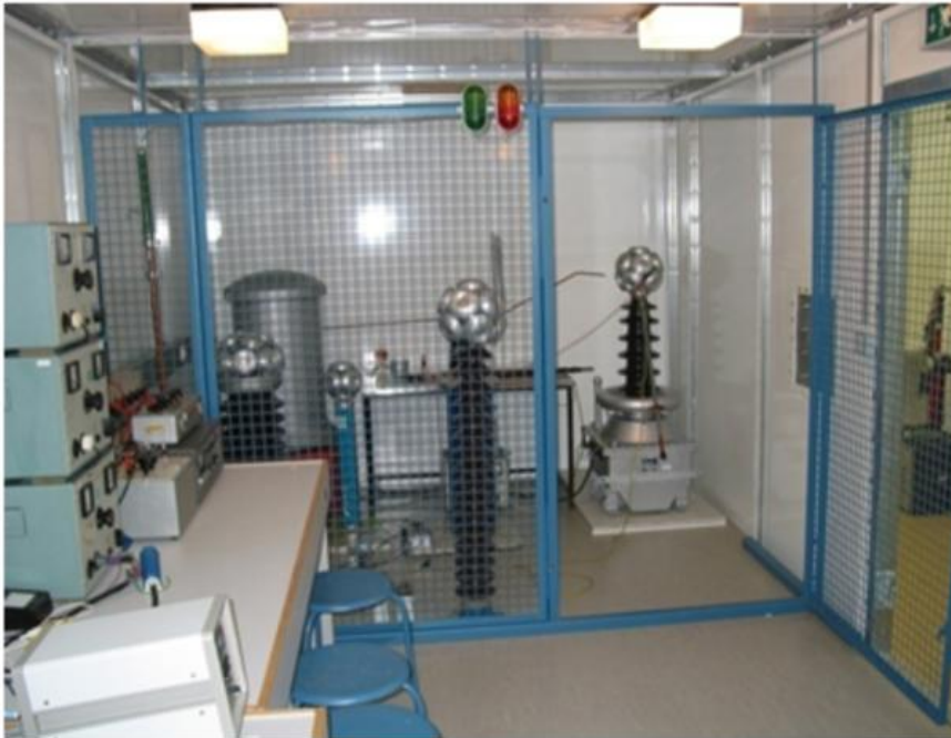
Abbildung: Geschirmte Messkabine zur Teilentladungs- und Verlustfaktormessung
