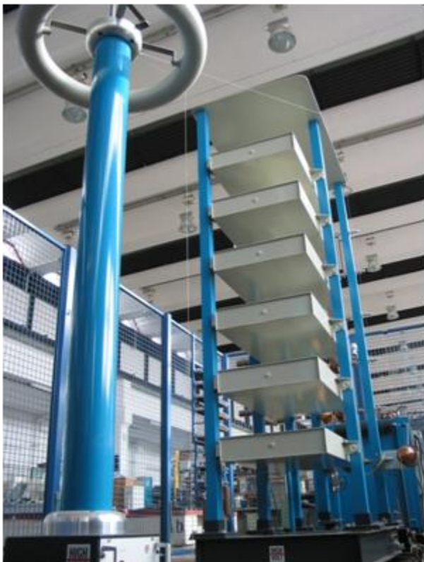
Abbildung: Geschirmte Messkabine zur Teilentladungs- und Verlustfaktormessung
